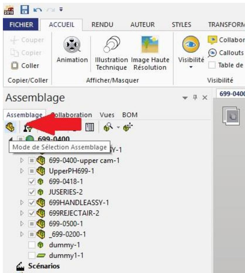
Une autre possibilité est de sélectionner une pièce, puis d'utiliser la touche directionnelle gauche du clavier pour sélectionner l'assemblage parent.
