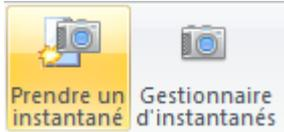
Lorsque vous souhaitez sauvegarder des version de projets SOLIDWORKS Electrical, vous faites plusieurs copies de projets. Depuis SOLIDWORKS 2016, il existe une solution pour éviter cela, il s'agit de l'option « Prendre un instantané ».
